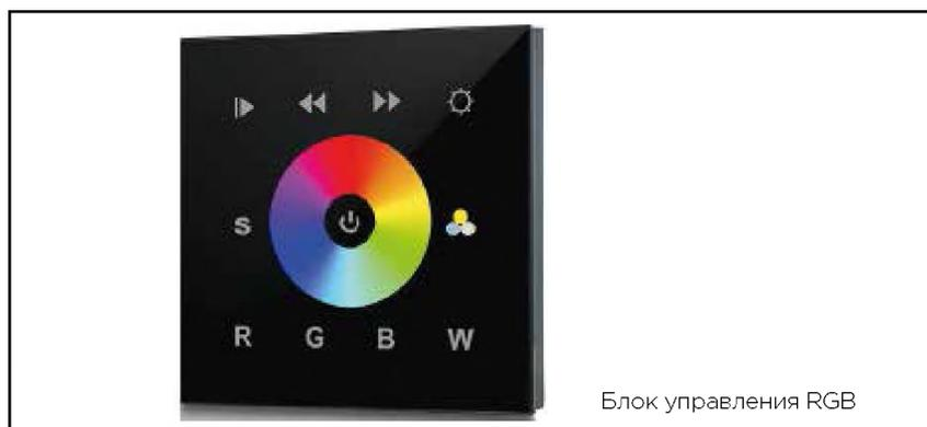
Для управления мультицветным RGB-исполнением светильника FWL применяется DMX-панель. Выходной сигнал соответствует стандарту DMX512. Используется 4 канала управления: R, G, B, W и встроенные программы динамической смены цветов.
